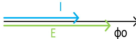
4.10 Фазорски дијаграм на напони и струи во коло со отпорник
