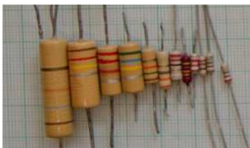
Отпорници со постојана (фиксна) отпорност, обележани со бои, наредени според максималната моќност на дисипацијата (од најголема до најмала)
